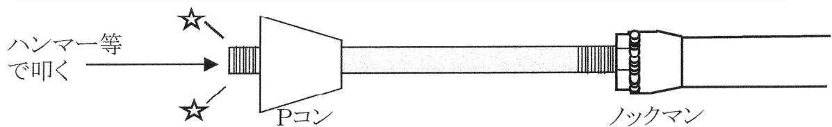
ノックマンは、Pコン側をたたいてセパの廻り止ができるため、配筋等の障害物があってもスムーズに作業ができ、山留めからの型枠施工の省力化に貢献します。また、Pコン側を叩く際には、Pコン打込み棒をご利用されると、ねじ部を傷つけずより一層効果的です。
